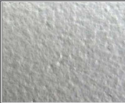
Verniciatura elettrostatica epossipoliestere, polimerizzata a forno. Colore RAL7035. Gli alloggiamenti vengono sabbiati prima della verniciatura per migliorare l'adesione. Questa è una finitura superficiale opzionale per gli alloggiamenti in alluminio (altri colori su richiesta).
