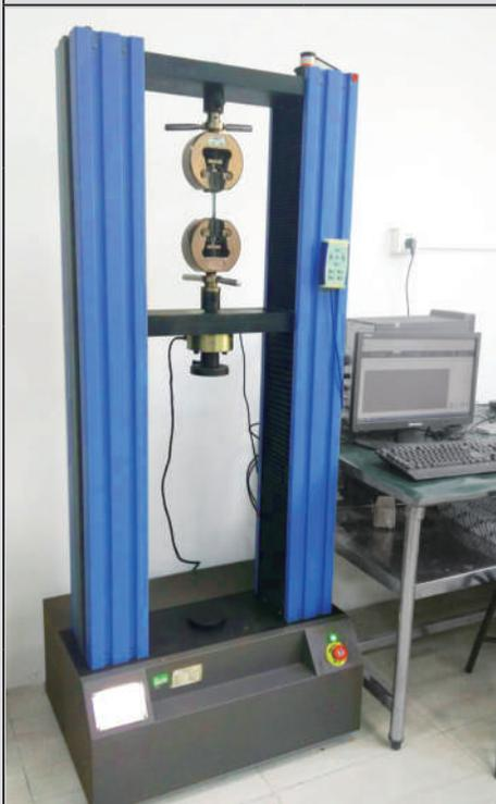
Apparecchiatura per la misurazione della resistenza alla rottura
